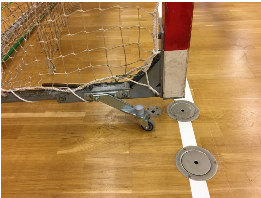
Billede 5. Målet må kun flyttes, når hjulene er ned. De må ALDRIG trækkes hen over gulvet
